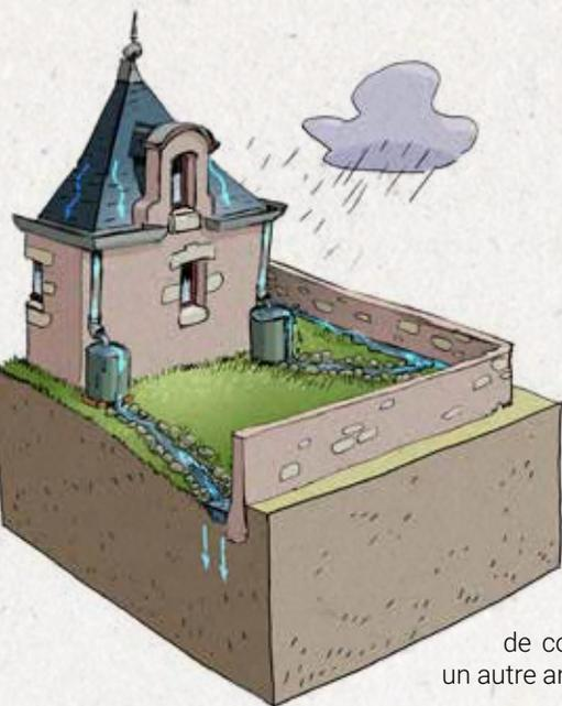
La concentration des précipitations annuelles sur la période automne/hiver impliquera de **gérer des quantités d'eau plus importantes sur des périodes plus courtes**. Les réseaux collectifs d'eau pluviale ne sont pas forcément dimensionnés pour absorber des épisodes pluvieux trop importants. Permettre une **infiltration de l'eau de pluie là où elle tombe** réduit le risque d'inondations par ruissellement et débordement des réseaux.
